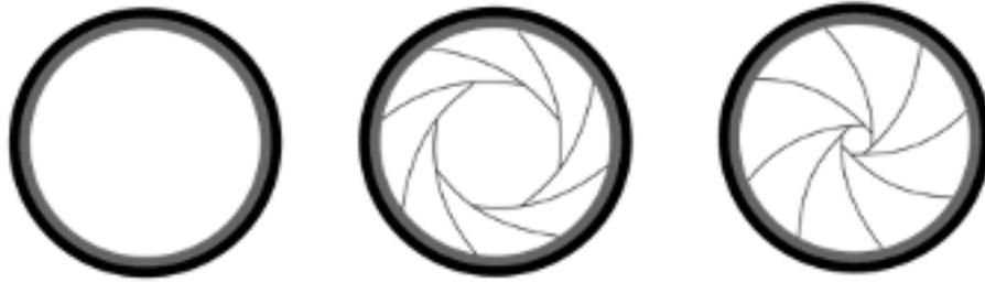
Schéma d'un diaphragme photo à iris. Ici avec trois ouvertures différentes de l'iris.
